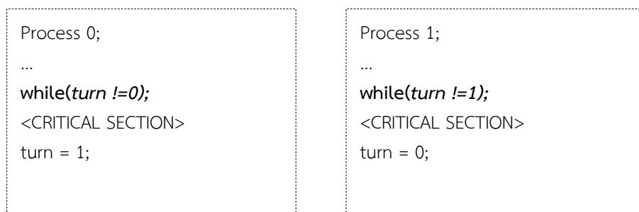
ภาพที่ 3.6 โครงสร้างภาษาที่ใช้อัลกอริทึมของเดกเกอร์ของโพรเซสส์ P0 และ P1
